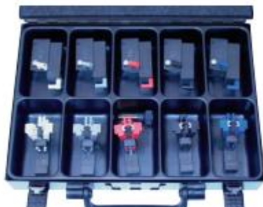
Wechselwerkzeuge 0,5 - 2,5 mm 2 Interchangeable Tools 0,5 - 2,5 mm 2
